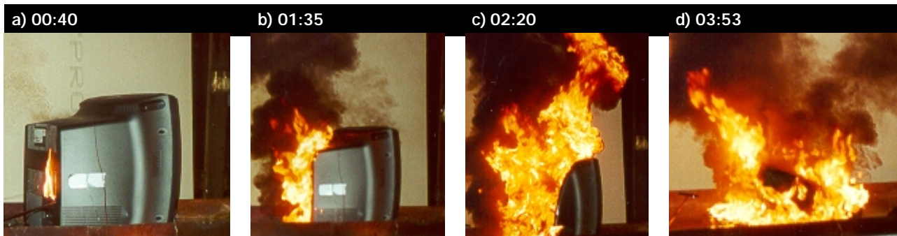
Kuva 2. Kuvasarja televisioiden polttokokeista.
