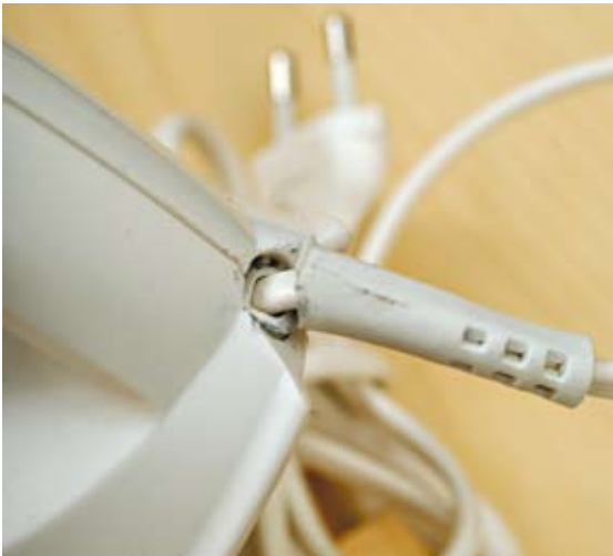
Sähkövatkaimen taiputussuoja on rikki eikä suoja enää johtoa murtumiselta.
