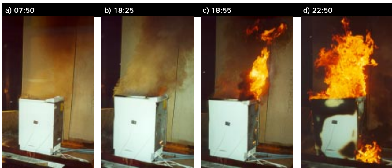
Bild 3. Bildserie från brandtesterna med tvättmaskin.
