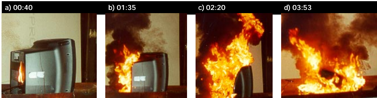
Bild 2. Bildserie från brandtesterna med TV-apparat.
