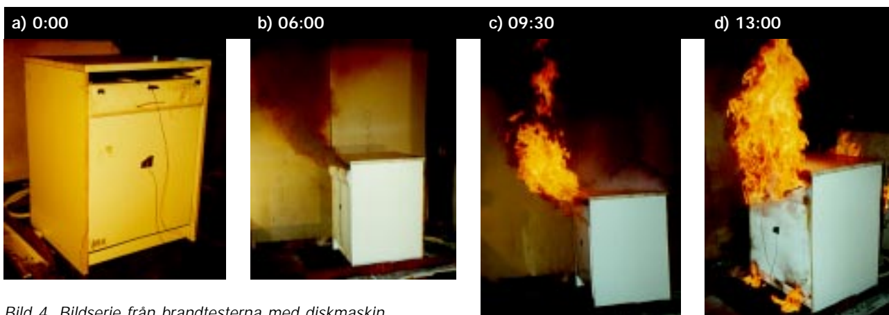
Bild 4. Bildserie från brandtesterna med diskmaskin.
