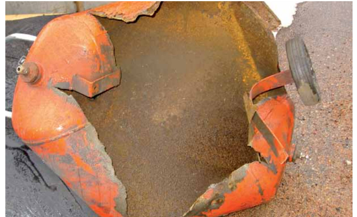
Sisäpuolisen syöpmän takia räjähtänyt ilmasäiliö.
